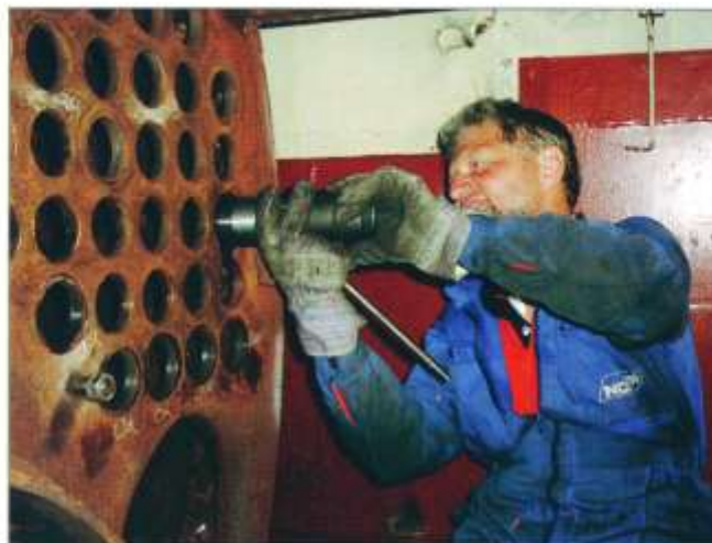
Carl-Johan Holm provar gängorna i passagerarbiens tuberna kan gängas i. Foto Åke Karlsson
